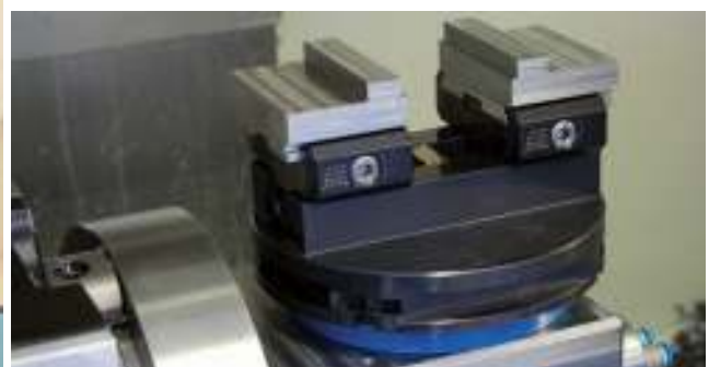
oppSystem in Anwendung mit Werkstückwechsler oppSystem in application with workpiece changer oppSystem en application avec le changeur de pièces
