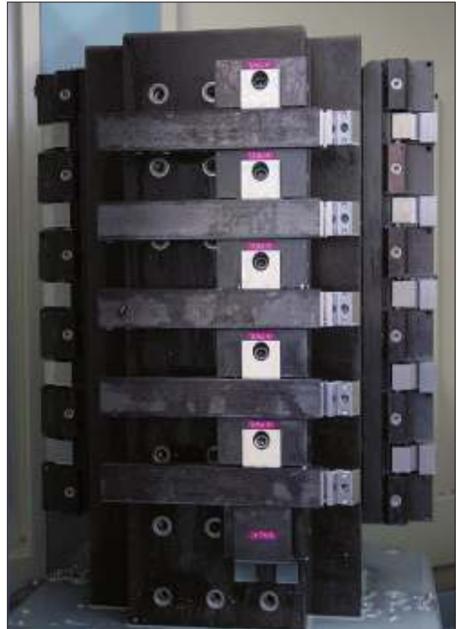
7 Aufspannung mit Power Clamp auf einem „Triproxy“ Mineralgussturm Set up with Power Clamp on a tombstone made of composite concrete Serrage Power Clamp sur une tourelle à minérale coulée
